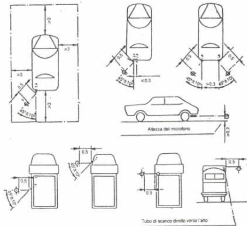
**Fig. 1 -Terreno di prova e posizioni del microfono per la misurazione a veicolo fermo (distanze in metri).**
