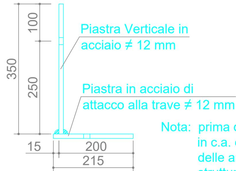
Nota: prima di eseguire le forature sulle strutture in c.a. e sul profilo, controllare la posizione delle armature esistenti nelle stesse strutture in c.a.
